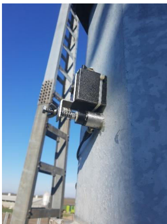
Slika 2 – Priklučenje sonde pomoću magneta
